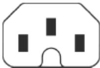
图 2: IEC 60320 C16 连接器
