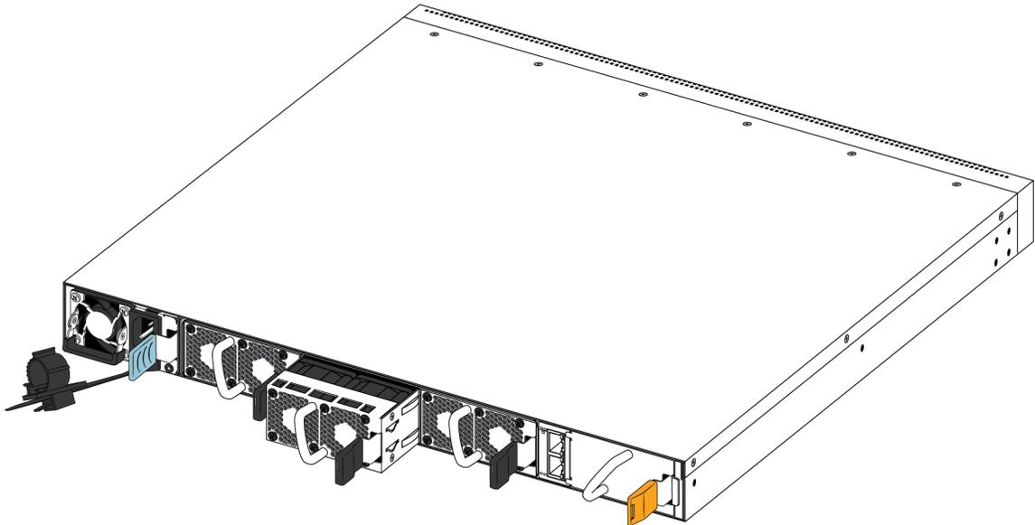
4. Insert the new fan module into the chassis.
