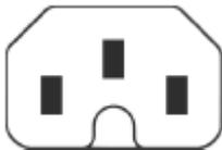
**Abbildung 5: C16-Anschluss IEC 60320**
