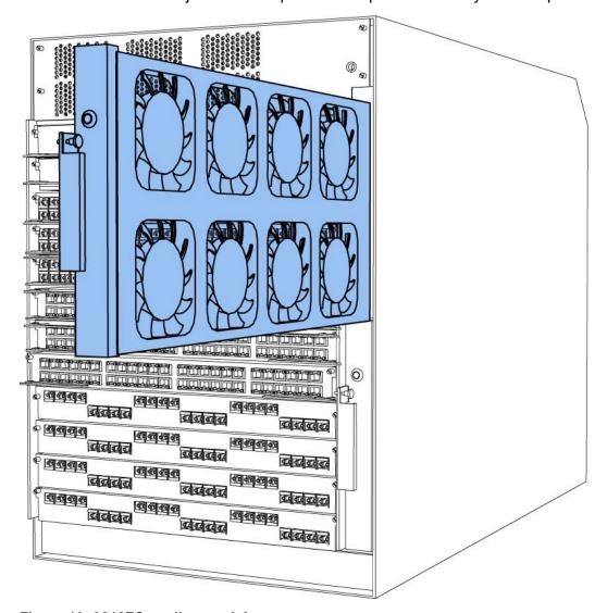
Figure 10: 9012FC cooling module
