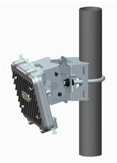
8. 使用扭矩扳手或棘齿及 10mm 套筒，或者使用可调扳手，通过角适配器支架的开放槽连接件及上孔中的 M6 六角法兰螺丝，将接入点支架完全安装至角适配器支架上。完成所有旋转和倾斜调节之前，请勿拧紧螺丝。
