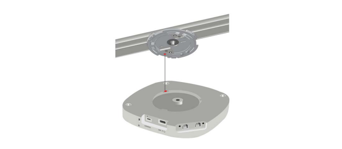
Figure 3 Alineación del punto de acceso con el punto rojo en la parte posterior del soporte -TB.
